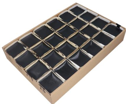
Für den Einsatz wird die empfohlene Fugenvergussmasse unter ständigem Umrühren auf 160° - 180°C erhitzt. Die Einbringung erfolgt mittels Schnabelkanne oder Vergusslanze, wobei überschüssige Vergussmasse mechanisch entfernt werden muss.
